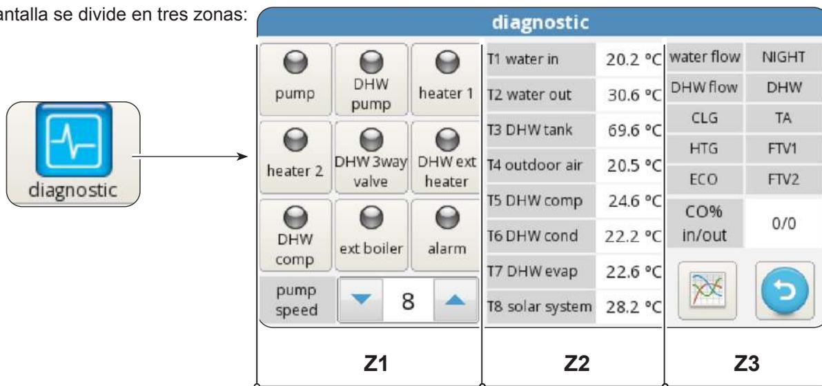
**Z1. Estado de activación de los componentes conectados al cuadro de la unidad interna (acceso rojo con estado activo):**
