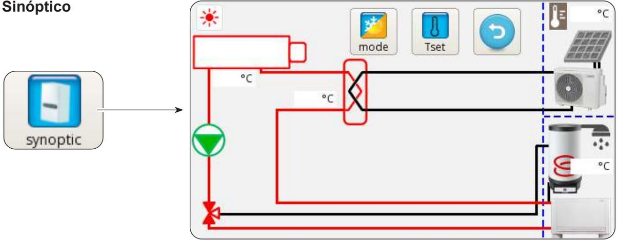
El sinóptico representa el esquema de sistema y muestra el estado de funcionamiento en tiempo real.
