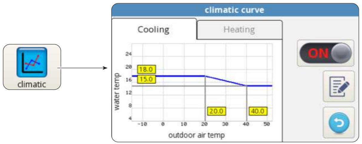
Per ottimizzare il risparmio energetico, sono disponibili due curve climatiche, una per il riscaldamento ed una per il raffreddamento. Esse permettono di adeguare la temperatura dell'acqua alla temperatura dell'aria esterna e quindi al carico termico.
