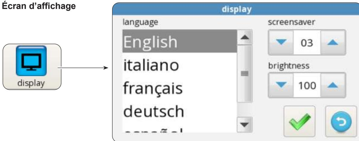
La page-écran permet de sélectionner la langue, de régler le délai de démarrage de la fonction d'économiseur d'écran et de régler la luminosité de l'écran.
