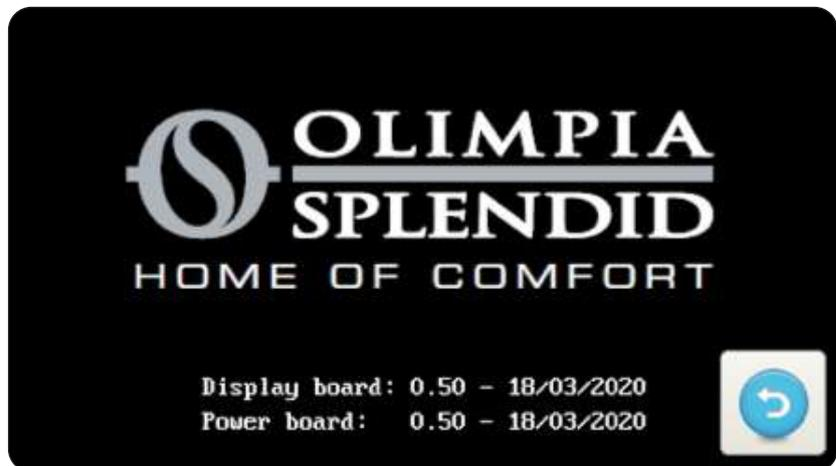
La schermata mostra la versione caricata del software della scheda display e di software scheda di potenza.
