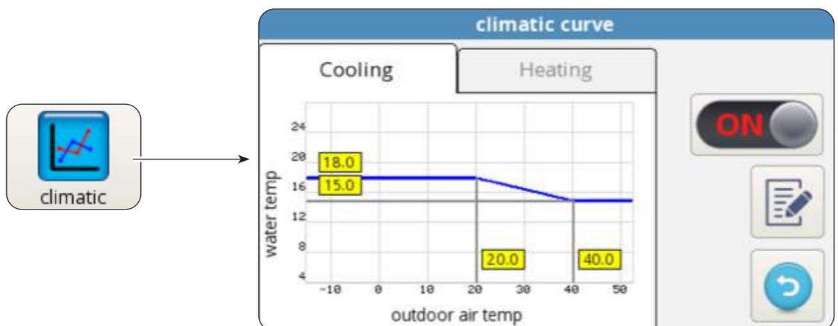
Zur Optimierung des Energiesparbetriebs sind zwei Klimakurven verfügbar, eine für den Heiz-, eine für den Kühlbetrieb.
