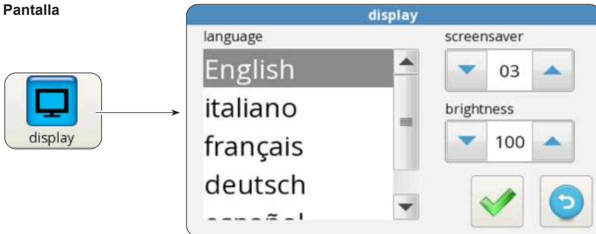
La pantalla permite seleccionar el idioma, configurar el tiempo de retraso del inicio de la función de protección de pantalla y configurar la luminosidad de la pantalla.
