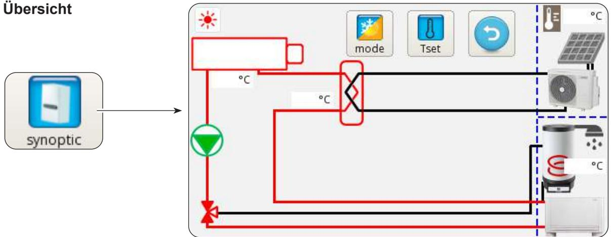
Die Übersicht ist eine Darstellung des Anlagenplans, bei welcher der Betriebsstatus in Echtzeit angezeigt wird.
