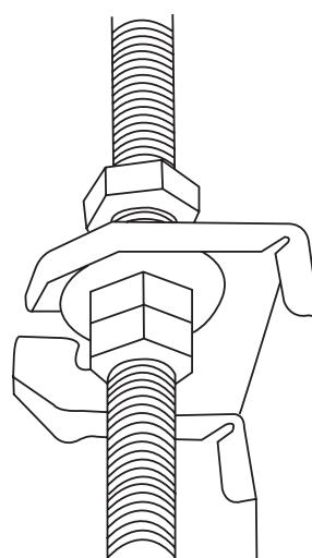
**NOTA:** la parte inferiore dell'unità deve essere più alta di 24 mm rispetto al pannello del soffitto. In generale, la L (indicata nella Fig. 5) dovrebbe essere la metà della lunghezza del bullone di sospensione o abbastanza lunga da impedire che i dadi si distacchino.
