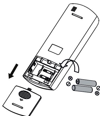
1 Per la sostituzione delle batterie, non utilizzare batterie vecchie o di tipo diverso. Ciò potrebbe provocare dei malfunzionamenti del telecomando.
