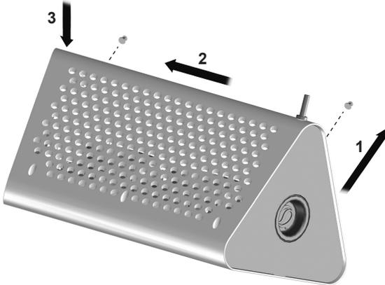
Hängen Sie das Gerät an die 2 zuvor an der Wand befestigten Schrauben, wie in der Sequenz in der Abbildung (Abb. 4) angegeben und wie unten beschrieben.
