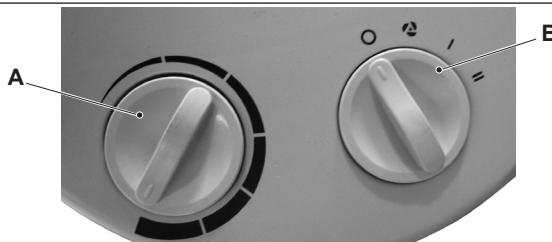
Per attivare il motore di ventilazione, ruotare la manopola del termostato (fig. 1 rif. A) in senso orario fino alla posizione max, ruotare quindi il selettore di potenza (fig. 1 rif. B) da 0 (OFF) a (ventilazione) e verificarne il corretto funzionamento.
