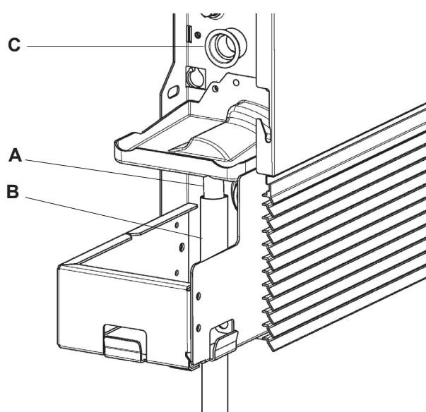
**Montaje del dispositivo de descarga de la condensación en la versión vertical**
