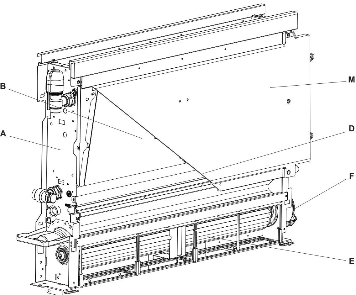
**D - Pannello radiante** ad elevata efficienza collegata alla batteria ad acqua calda (versione SLR). Per le versioni a due tubi il gruppo idraulico è dotato di una valvola calostat che impedisce l'ingresso dell'acqua fredda al pannello.
