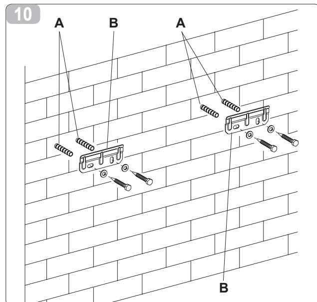
**INSTALACIÓN VERTICAL EN LA PARED O EN EL PISO**
